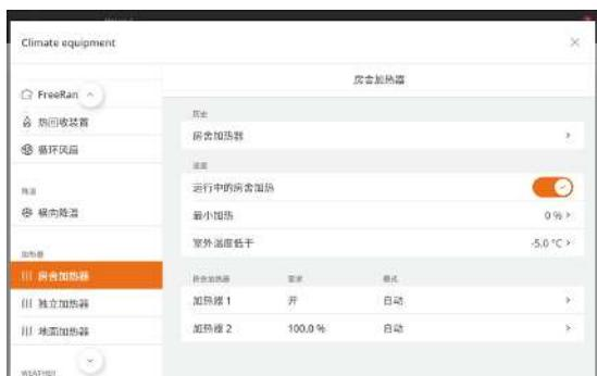
最小加热是房舍控制器在寒冷天气中启用的一项功能。举例来讲，最小加热可以尽量减少进风口结冰。当室外温度设定为**室外温度低于**时，房舍控制器将不断增加最小加热。
