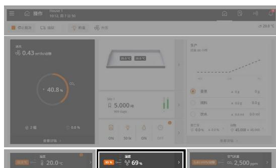
**操作**。通过温度卡片可以查看并调整最重要的温度数值。卡片的正面显示当前的室内温度以及所需的空气湿度。以下章节内容介绍了可用于湿度的功能和设置选项。
