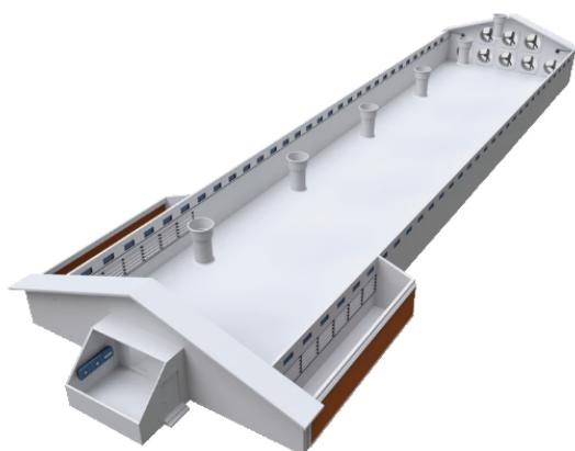
联合纵向通风和在气候条件变化时即室外温度从非常冷变为非常热的时候，可以提供最好的生产力条件。
