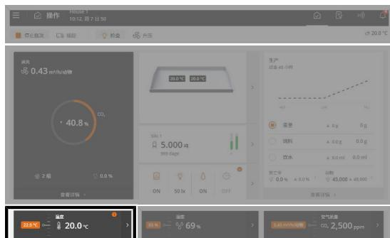
**操作。**通过温度卡片可以查看并调整最重要的温度数值。卡片的正面显示当前的室内温度以及温度设定点。
